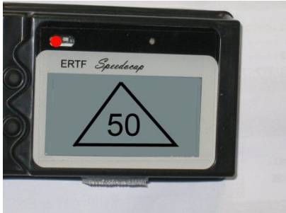
Pantalla de señalización de entrada en DZ
